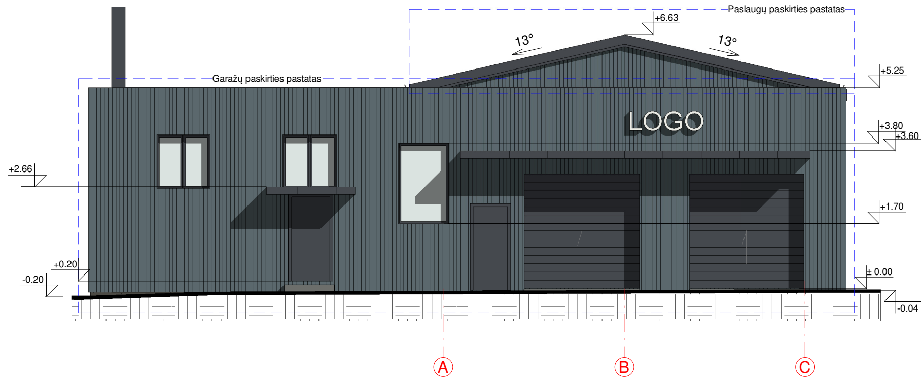
FASADAS TARP AŠIŲ A-C M1:100
