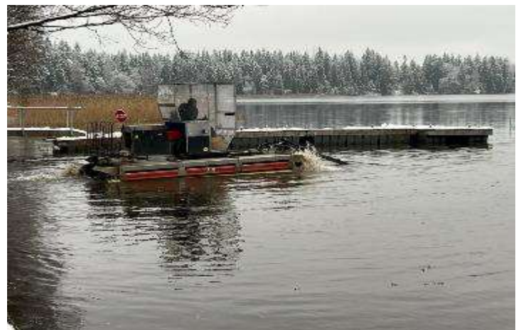
16, 17 pav. Dugno frezavimo darbai Platelių bei Beržoro ežeruose
