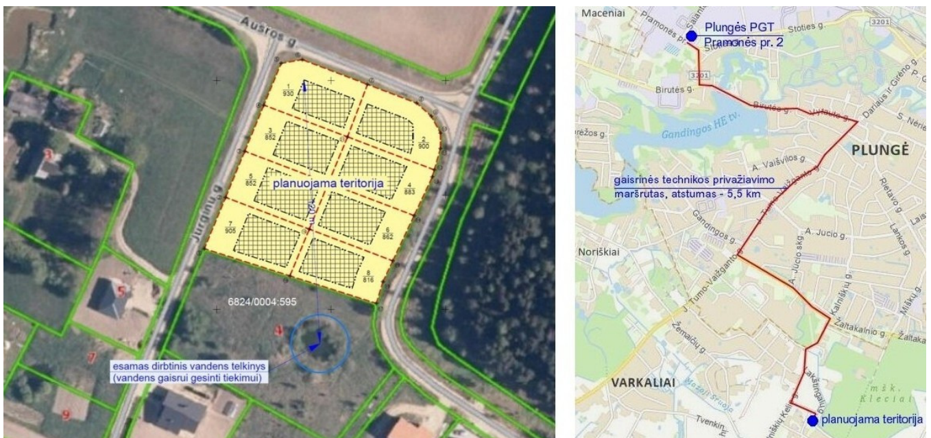
19 pav. Vandens telkinių išsidėstymo ir gaisrinės technikos privažiavimo maršruto schemas
