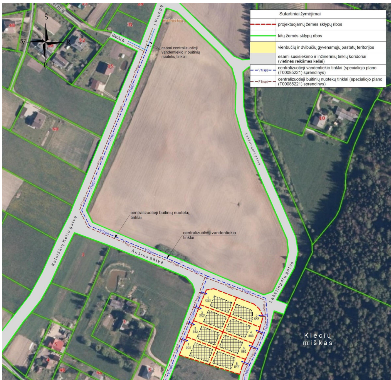
18 pav. Centralizuotųjų vandentiekio ir nuotekų tinklų schema
