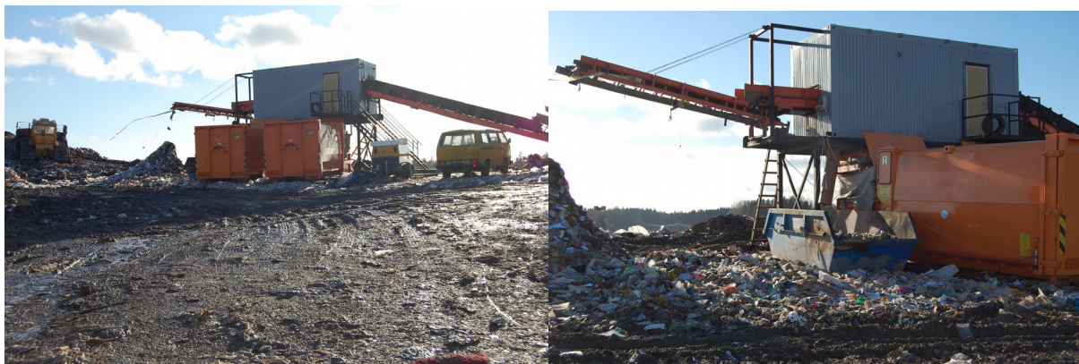
24 pav. Mobili mišrių komunalinių atliekų rūšiavimo linija
